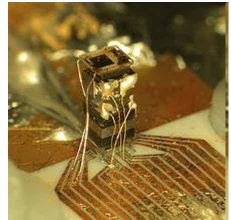
Miniaturowy zegar cezowy: średnica 1.5 mm, wysokość 4 mm 37
